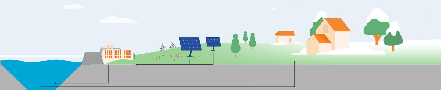
Die Solarthermieanlage erhitzt das Wasser. Das erwärmte Wasser wird dann im Betriebsgebäude mit Wärmetauschern richtung Becken gepumpt. Hier bleibt es bis im Winter warm und wird dann genutzt um nahe gelegene Häuser zu heizen.
